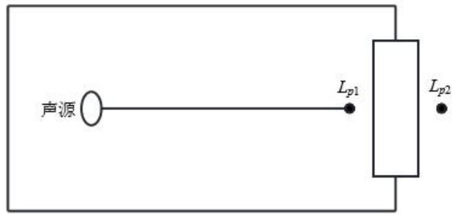
图 4-2 室内声源等效为室外声源图例
