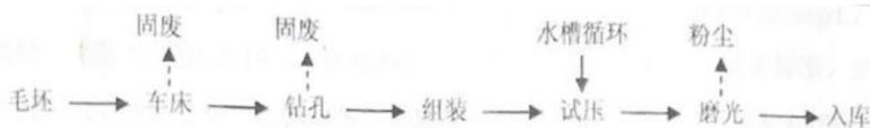
图 2-5 现有项目生产工艺流程图
